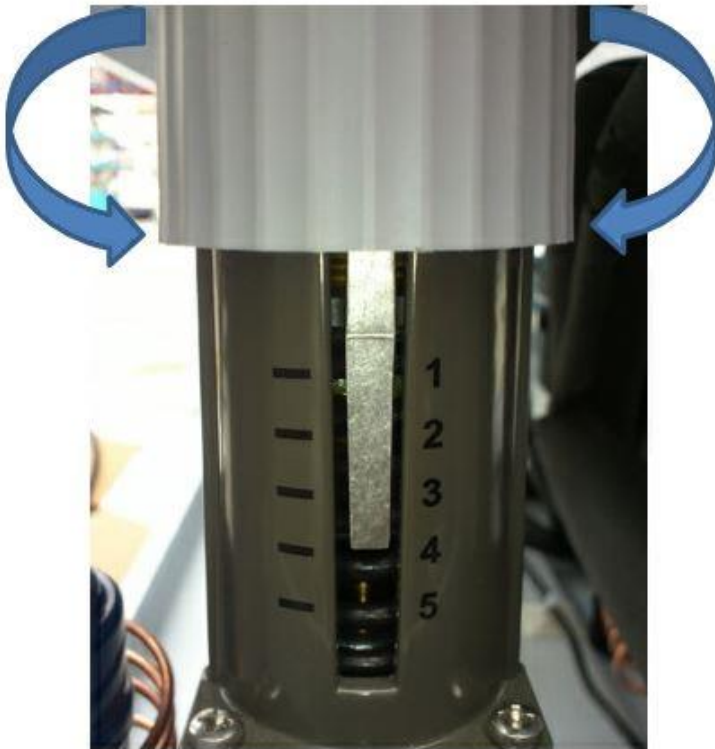
Bild 3 Durch Drehen des Einstellrades in Richtung 1 auf der Skala wird die Kühlwassermenge erhöht und durch drehen in Richtung 5 auf der Skala wird die Kühlwassermenge reduziert.
